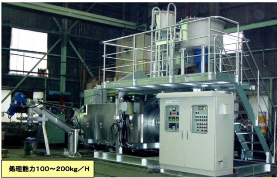
焼却炉解体発生物および汚染土壌中のダイオキシン類無害化装置(可搬式)
