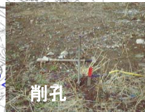
調査事例：5mメッシュの交点の1m深地温を測定
