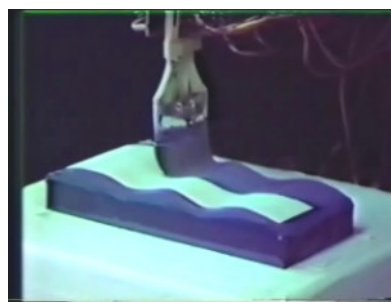
波状の板にペンキを塗る作業 (教示データの座標変換と力制御モードによる再生)
