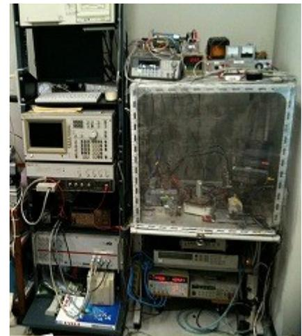
概要としては、材料に電極を形成して超高感度微小電流計を接続し、材料に熱・光などの刺激を与えたときのわずかな電流応答を捉えることで、材料内に存在する結晶欠陥による電子の移動を検出する。材料としてBaTiO<sub>3</sub>やPbTiO<sub>3</sub>のセラミックス系で実績があるが、温度・電圧の工夫で他の材料でも同様な分析ができる。
