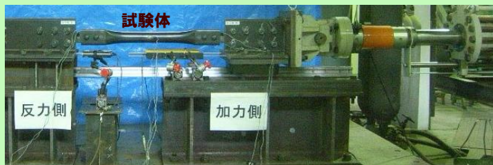
高力ボルト接合要素部材の载荷実験の様子
