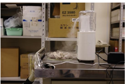
15%FA浸漬豚肉に超音波噴霧器(右)でIFRを散布し対側から吸引(左)。
